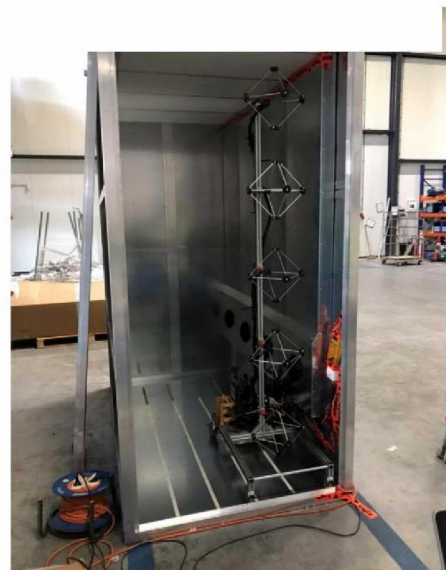
Luchtbehandelingssysteem ingebouwd in mockup met meetopstelling voor luchtstromingen
